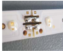
Lötbrücken bei EasyLED Mono
